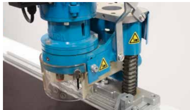
Rys. 4: Przesuwana tarcza ochronna na wrzecionach wiertarskich
